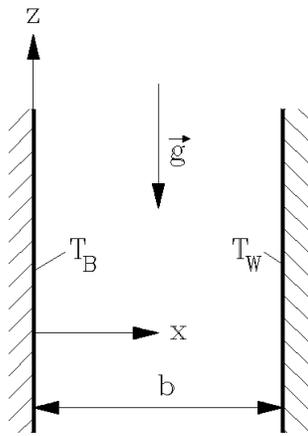
Zwischen zwei Wänden, die durch Heizungen auf konstanter Temperatur  $T_B$  (an  $x=0$ ) bzw.  $T_W$  (an  $x=b$ ) gehalten werden, befindet sich Wasser der Viskosität  $\eta$  ( $\eta = \text{const}$ ). Da Wände und Flüssigkeit in  $y$ - und  $z$ -Richtung unendlich ausgedehnt sind, ist die sich einstellende Temperatur des Wassers  $T(x)$  nur eine Funktion von  $x$ . Die Dichte des Wassers ist temperaturabhängig:
