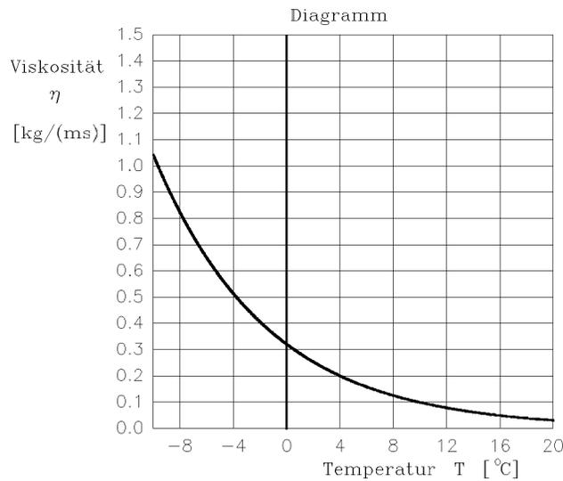
Bei sehr niedrigen Außentemperaturen kann Rohöl nur deshalb bei erträglichem Druckabfall durch Pipelines gepumpt werden, weil sich das Öl aufgrund der Dissipation erwärmt und somit die Scherviskosität abnimmt. Der Viskositäts-Temperatur-Zusammenhang für Rohöl ist im gezeigten Diagramm aufgetragen.
