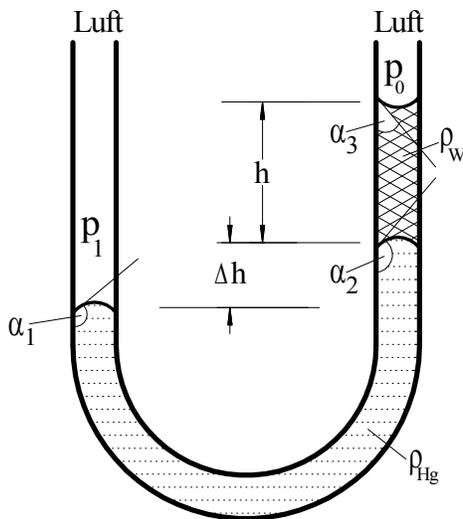
Ein dünnes U-Rohr (Radius  $r$ ), bei dem Kapillareffekte nicht vernachlässigt werden dürfen, ist mit Quecksilber ( $\rho_{Hg}$ ) und Wasser ( $\rho_w$ ) gefüllt. Berechnen Sie die Druckdifferenz  $p_1 - p_0$ ! (Die Kapillaritätskonstanten  $C_i$ , die Randwinkel  $\alpha_i$  sowie  $r$ ,  $\Delta h$  und  $h_1$  sind bekannt). Schätzen Sie mit den gegebenen Daten ab wie groß der relative Fehler ist, wenn man die Kapillareffekte vergißt.
